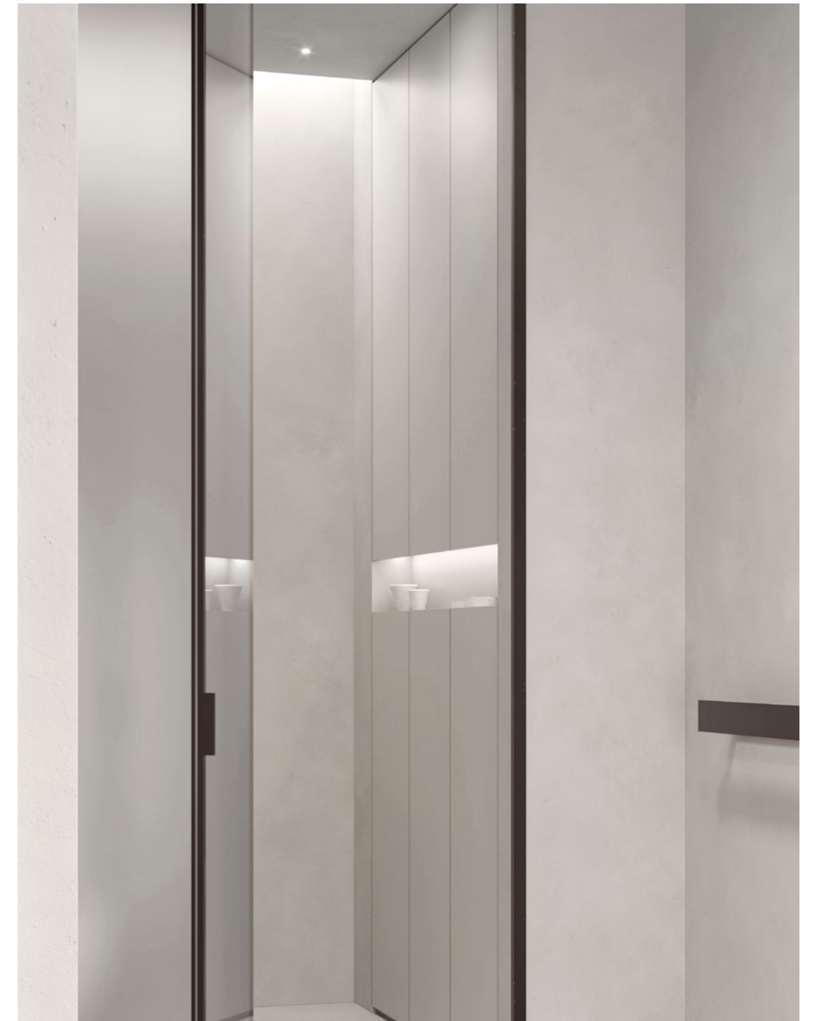
Parete sistema Trend Master a chiusura di una zona dedicata ai sanitari, struttura in alluminio verniciato e vetro satinato.
